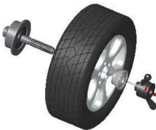
Рисунок 3. Способ установки колеса гайкой наружу.
