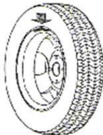
Рисунок 11. Место установки противовеса внутри колеса.
