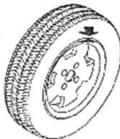
Рисунок 10. Место установки противовеса снаружи колеса.
