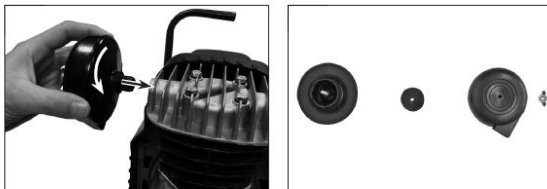
Рисунок. Установка воздушного фильтра.
