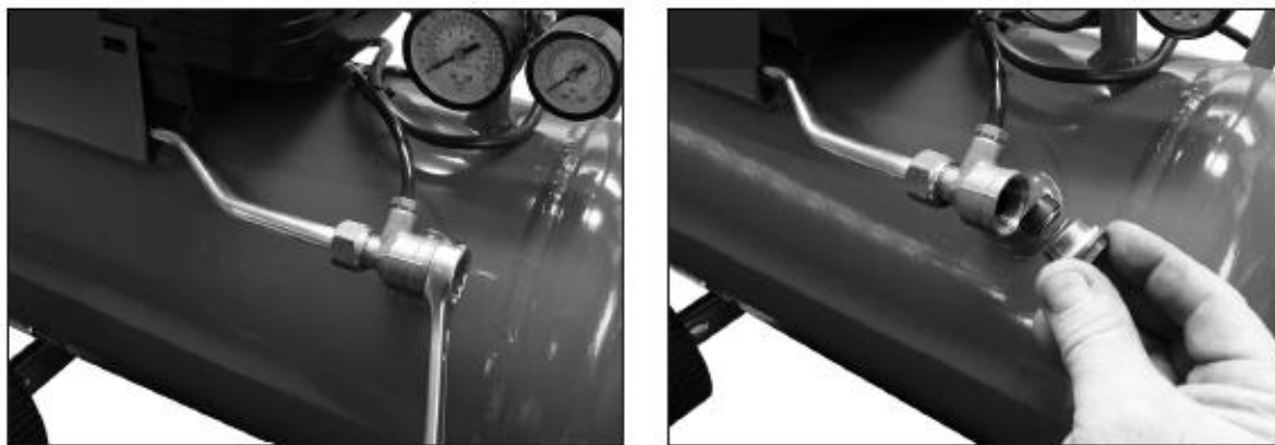
Рисунок. Очистка датчика давления воздуха.
