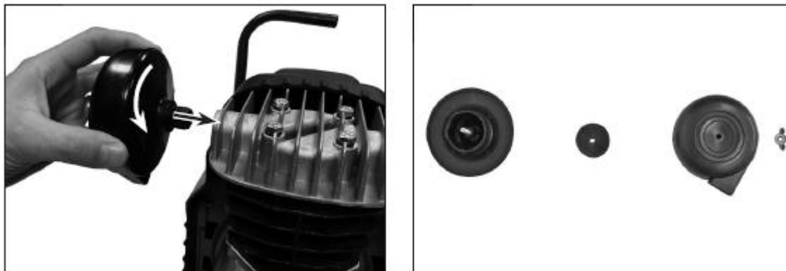
Рисунок. Установка воздушного фильтра.
