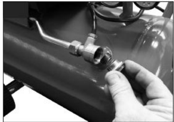
Рисунок. Очистка датчика давления воздуха.
