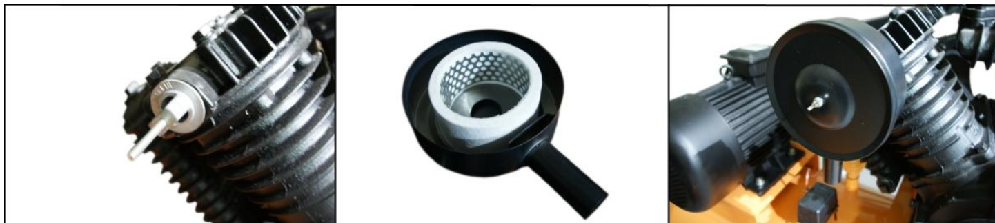
Рисунок. Установка воздушного фильтра.
