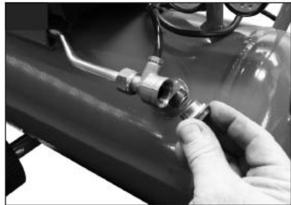
Рисунок. Очистка датчика давления воздуха.
