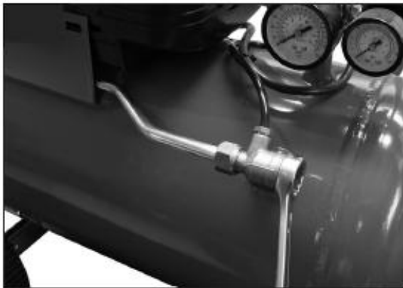
Рисунок. Очистка датчика давления воздуха.
